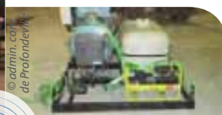
Désherbeur thermique à vapeur employé par la Commune de Profondeville
